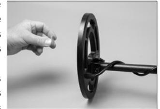
Une fois familiarisé avec l'affichage des cibles sur les curseurs d'identification du détecteur au cours de vos essais, vous pouvez passer aux essais sur le terrain. Entrez vos cibles à une profondeur déterminée pour créer un graphique de test. Notez la précision de la détection de ces cibles en fonction de leur orientation dans le sol, à plat ou dans un certain angle.
