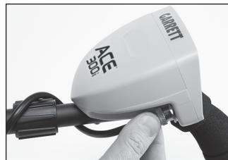
Nota: El brazalet puede ajustarse quitando el tornillo en la parte inferior y moviéndolo al siguiente orificio.
