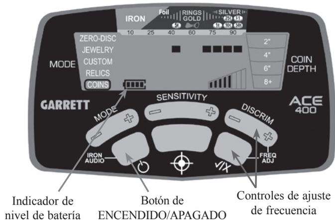
**Encendido/apagado:** sostenga este botón durante 1 segundo para ENCENDER o APAGAR el detector.
