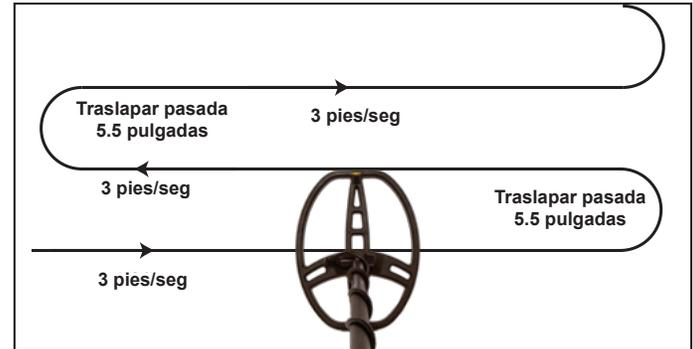
Para explorar completamente un área, traslape las pasadas de su bobina de exploración a la mitad de la longitud de la bobina (alrededor de 5.5 pulgadas). Pase la bobina de exploración en una línea recta o con un leve arco a una velocidad de pasada de alrededor de 3 pies/segundo.
