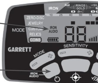
Presione y suelte el botón IRON AUDIO (audio de hierro) para ENCENDER/APAGAR la función de audio de hierro.
