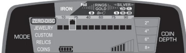
**Nota:** Los cambios realizados al patrón de discriminación de niveles mientras está en el modo CUSTOM (personalizado) se conservarán cuando el detector se apague. Los cambios realizados a todos los otros modos regresarán a los ajustes de fábrica cuando el detector se apague y se vuelva a encender.
