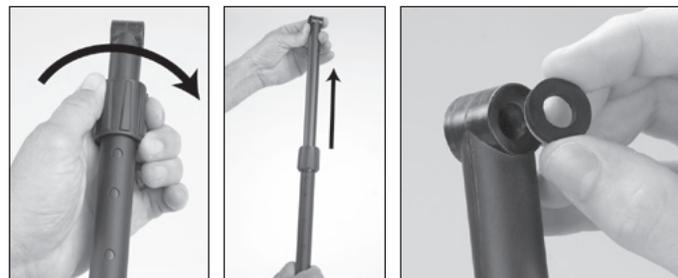
Afloje la leva de fijación superior, inserte el vástago S en el alojamiento de control, ajuste el vástago inferior a una longitud cómoda y apriete manualmente las levas de fijación. Envuelva firmemente el cable alrededor del vástago pasando la primera vuelta del cable por encima del vástago.
