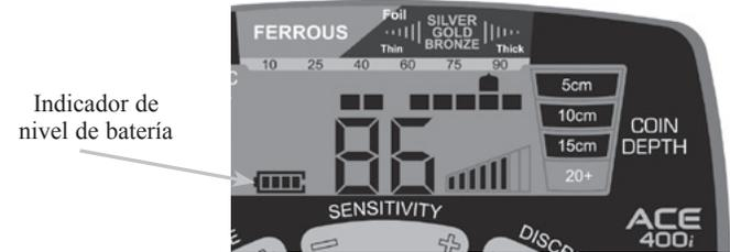
Cuatro barras indican que las baterías están completamente cargadas. Cambie las baterías cuando solo quede una 1 barra. El detector mantendrá su desempeño total hasta que las baterías necesiten cambiarse. Pueden usarse baterías recargables de NiMH, pero pueden tener una vida útil más corta por carga. Puede anticipar 20 a 40 horas de operación dependiendo del tipo y la calidad de las baterías.
