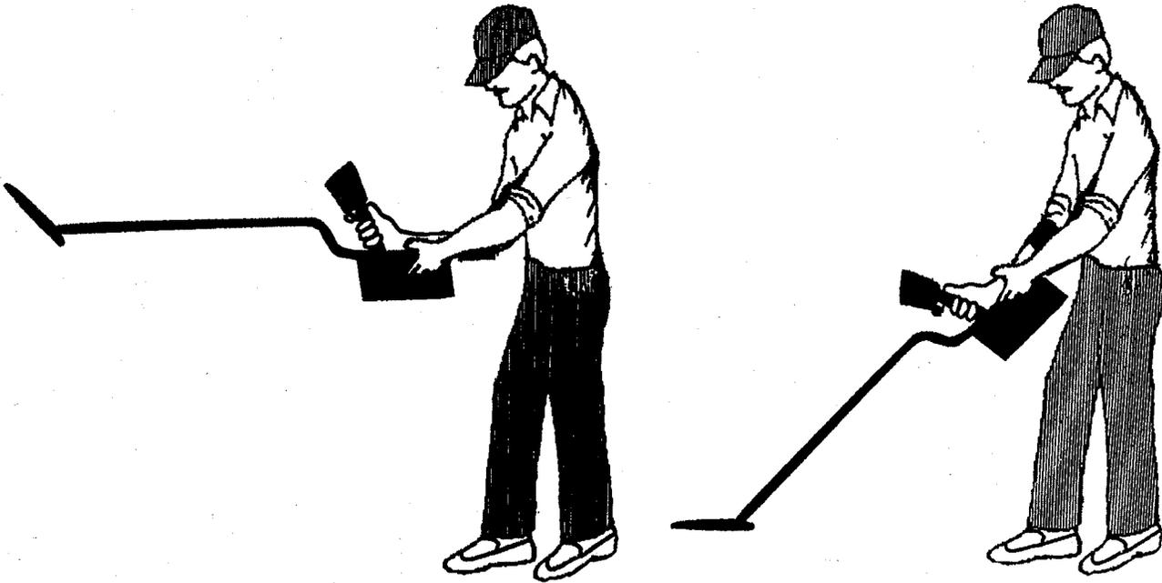
4. Levante el aro del piso mientras escucha para cualquier cambio dramático en el zumbido continuo (umbral) del detector. Si no hay un cambio significativo en el zumbido continuo (umbral) el detector está afinado y listo para usar, vaya al número 6 en la página ocho. Si el zumbido continuo (umbral) cambió dramáticamente cuando el aro fue levantado del piso, más ajustes son necesarios. Proceda con el paso número 5 abajo.
